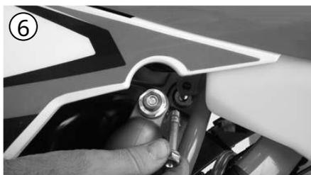
8. Retirez le boulon de fixation supérieur de l'amortisseur au cadre (6).
