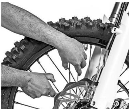
Est-ce ainsi **Les rayons de la la roue bien tendu ?** En les serrant avec nos doigts, nous pouvons remarquer leur possible manque de tension. En cas de jeu excessif dans l'un d'eux, tous et les deux roues doivent être vérifiés, c'est un travail d'experts, nous vous recommandons de vous adresser à votre service officiel RIEJU.
