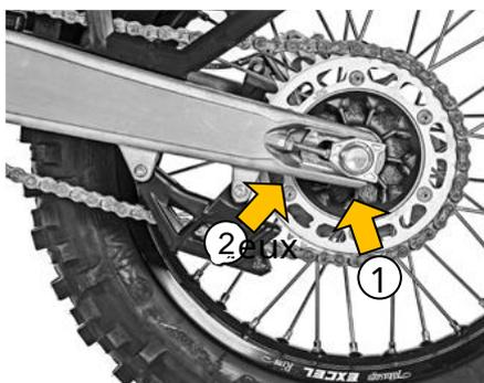
La tension de la chaîne est un contrôle constant. Il doit être utilisé pour vérifier visuellement l'état de la chaîne elle-même, du patin de guidage, du guide, du pignon et du
