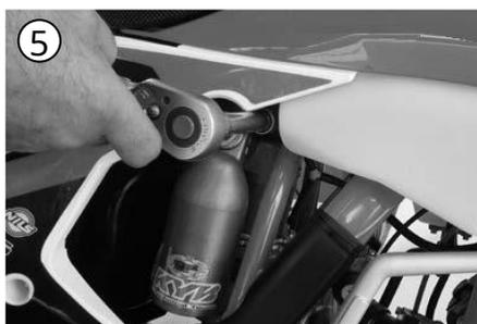
7. Desserrez l'amortisseur supérieur sur le boulon du cadre (5).
