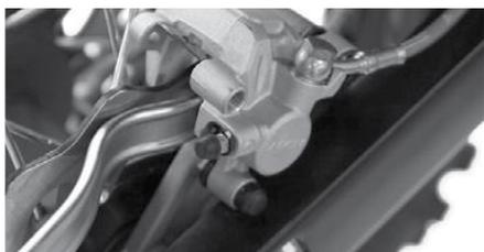
7. Rétractez le piston de l'étrier en veillant à ne pas l'endommager.
