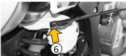
5. Desserrez les vis (6) et retirez le bouchon du réservoir de liquide de frein.
