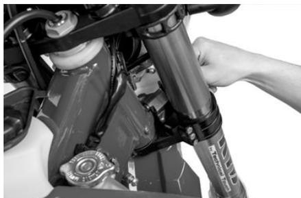
Votre RIEJU est équipé d'un antivol antivol de direction. Il est situé sur le côté droit du flasque inférieur de fourche. Pour bloquer l'adresse :
