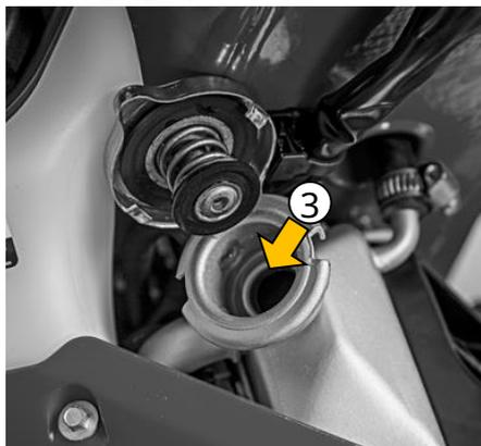
**Le niveau de liquide de refroidissement est-il ?** En retirant le bouchon de remplissage du radiateur, le niveau de liquide de refroidissement peut être vérifié. Celui-ci doit être juste en dessous du bord métallique (3), si nécessaire, ajoutez.
