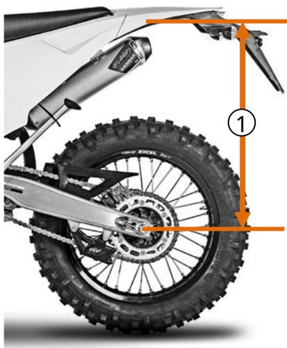
**AJUSTEMENT STATIQUE INITIAL (SAG)** Pour régler le pré-affaissement de la suspension, suivez ces étapes :
