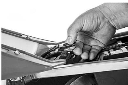
Pour connecter l'outil d'analyse Creader VI+ (ou similaire), la protection doit être retirée du connecteur.
